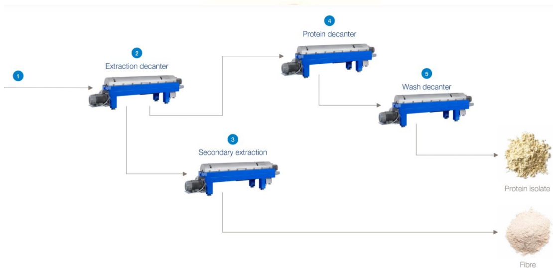
شکل ۱۳- دستگاه تولید فیبر رژیمی از پوست فندق و تفکیک پروتئین آن
