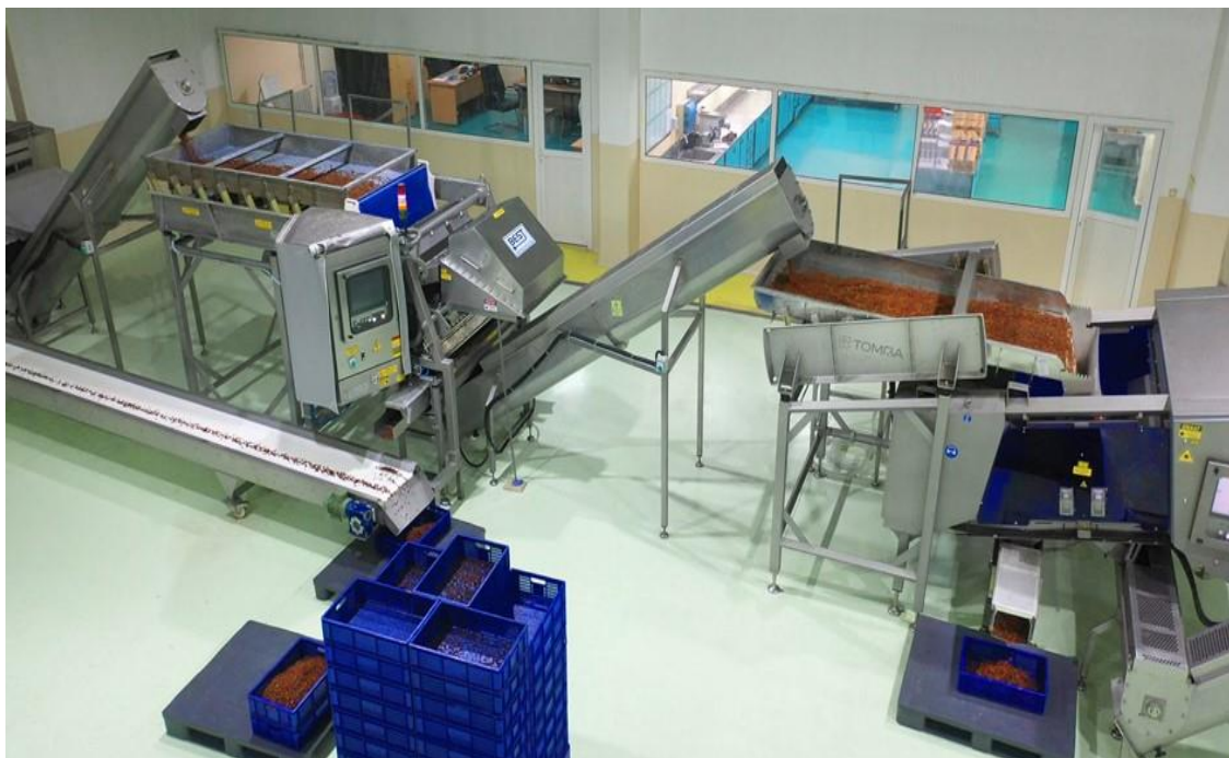
شکل ۱۰ (ث) - نمونه ای از خط تولید دستگاه سورتینگ فندق با ماشین آلات TOMRA
